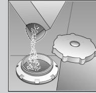
Max. 1,5 kg Spezzalz (nie Reiniger!) einfüllen.
