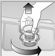
Siebzylinder drehen, Siebsystem entnehmen ...
