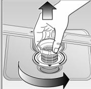
Siebzylinder drehen, Siebssystem entnehmen ...
