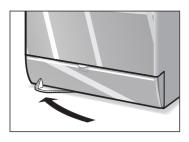
A l'avant de l'appareil, basculez le levier de la droite vers la gauche. L'appareil repose désormais sur ses roulettes.
