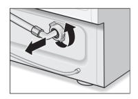
☐ Dévissez le raccord unissant le flexible d'arrivée d'eau et l'orifice d'entrée dans la machine.
