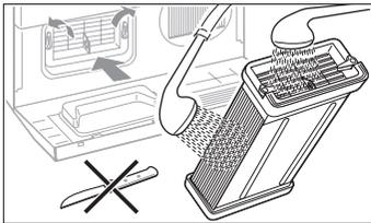
7. Luftkühler vollständig reinigen, Wasser gut abtropfen lassen.
