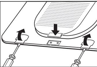
5. Abdeckung für Scharnier-Befestigungspunkte vorsichtig aushebeln.
