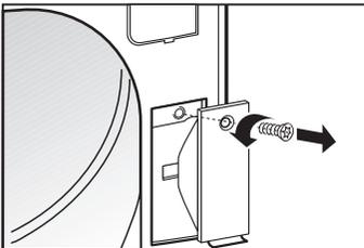
4. Schraube der Abdeckung des Türverschlusses heraus-schrauben. Abdeckung abnehmen.
