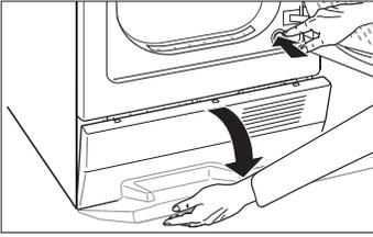
1. Restwasser kann austreten, ein saugfähiges Tuch unter die Wartungsklappe legen.
