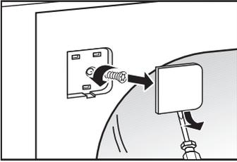
1. Beide Abdeckungen der Tür-Befestigungspunkte entfernen: Mit Schlitz-Schraubendreher vorsichtig aushebeln.
