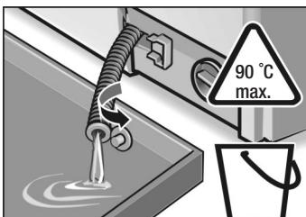
Verschluss-Kappe abziehen und Waschlauge in bereitstehendes Gefäß abfließen lassen.
