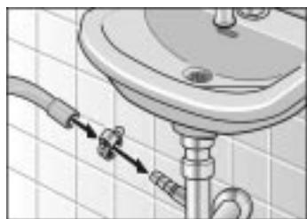
En caso de efectuar el desagüe a través de un lavabo:
