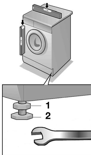
L'appareil doit être installé de manière ferme et en position horizontale sur ses quatre supports et ne doit pas osciller.
