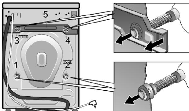
Les pièces des sécurités pour le transport de l'intérieur de l'appareil se détachent et tombent au sol, sous la machine à laver.
