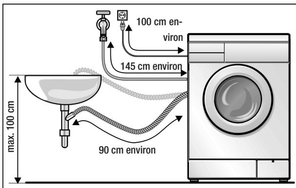
Connexion sur le côté droit de l'appareil
