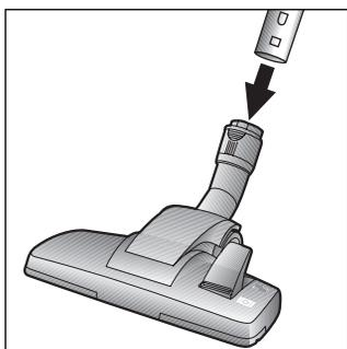
Teleskoprohr bis zum Einrasten in den Stutzen der Bodendüse schieben.
