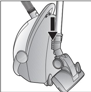
Zum Abstellen /Transportieren des Gerätes können Sie die Abstellhilfe an der Geräteunterseite benutzen. Gerät aufrecht hinstellen. Haken an der Bodendüse in die Aussparung an der Geräteunterseite schieben.
