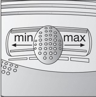
Durch Verstellen des Schiebereglers kann die gewünschte Saugkraft stufenlos eingestellt werden.
