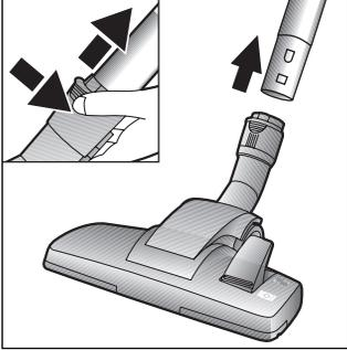
Zum Lösen der Verbindung Entriegelungshülse drücken und Teleskoprohr herausziehen.
