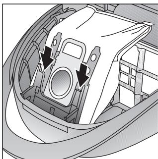
Neuen Filterbeutel bis zum Anschlag in die Halterung einschieben.
