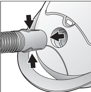
Zum Entfernen des Saugschlauches Entriegelungstasten drücken und Schlauch herausziehen.
