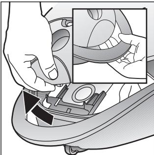
Deckel nach Betätigen des Verschlusshebels in Pfeilrichtung öffnen.
