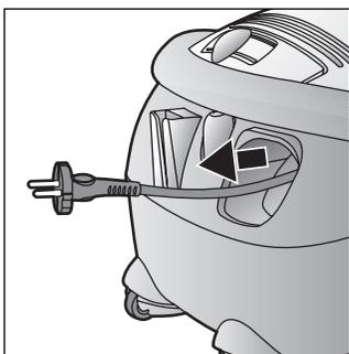
Netzanschlusskabel am Stecker greifen, auf die gewünschte Länge herausziehen und Netzstecker in Steckdose stecken.
