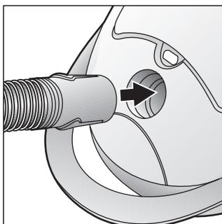
Saugschlauchstutzen in die Saugöffnung einrasten.
