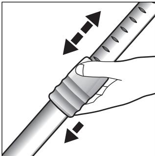
Durch Drücken der Schiebetaste / Schiebemannschette in Pfeilrichtung Teleskoprohr entriegeln und gewünschte Länge einstellen.
