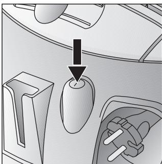
Staubsauger durch Betätigen der Ein- /Austaste in Pfeilrichtung einschalten.
