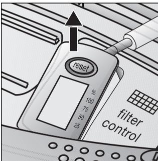
Um die Anzeige zu entfernen, setzen Sie einen Schraubenzieher in die Kerbe neben der Anzeige und drücken Sie sie heraus.
