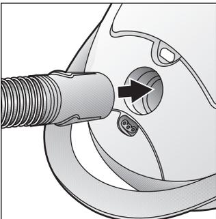
Saugschlauchstutzen in die Saugöffnung einrasten.
