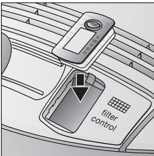
Die neue Ausblasfilter-Wechselanzeige kann ganz leicht durch Druck in Pfeilrichtung in der Blende des Gerätes verrastet werden.
