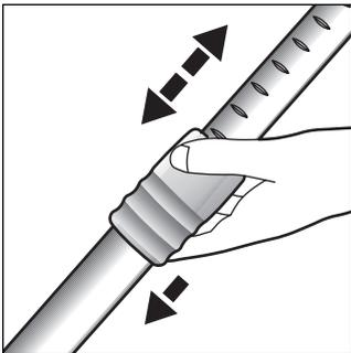
Durch Drücken der Schiebetaste / Schiebemanschette in Pfeilrichtung Teleskoprohr entriegeln und gewünschte Länge einstellen.
