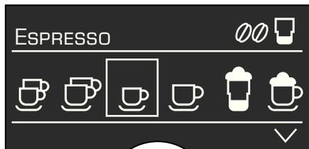
Nella riga di stato **5a** del display **5** viene visualizzato il nome del tipo di bevanda e il valore impostato per l'intensità, ad esempio ☉☉ e per la quantità, ad esempio ☐. La riga di selezione **5b** rappresenta i simboli per la selezione delle bevande. Le frecce nella riga di navigazione **5c** indicano in quale direzione sono disponibili ulteriori livelli di menu.
