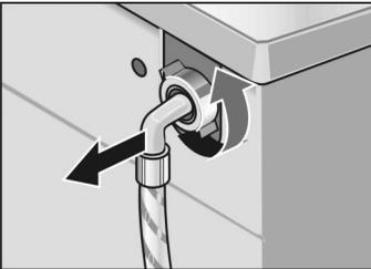
1. Schlauch an der Maschinenrückseite abnehmen.
