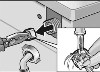
2. Sieb herausziehen und unter fließendem Wasser ausspülen.
