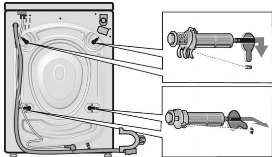
8. Transportsicherungen einsetzen und Schrauben festziehen. Nase der Scheiben muss in Nut der Gehäuserückwand greifen.
