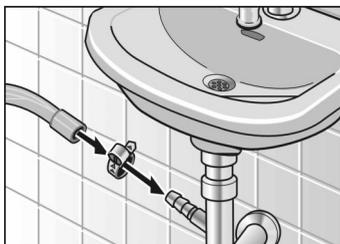
1. Anschluss-Stelle mit Schlauchschelle,  $\varnothing$  24–40 mm (Fachhandel) sichern.
