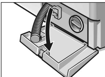
Extrayez le flexible de vidange de sa fixation et sortez-le du corps de l'appareil.
