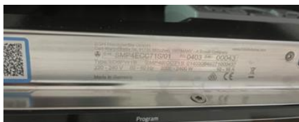
Exemplo da chapa de características de uma máquina de lavar loiça
