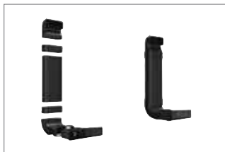
HEZ9VDKR1 montážna súprava na prevádzku s čiastočnou cirkuláciou pre varné dosky s odsávaním, na hĺbku pracovnej dosky 60 cm a väčšou (1x ploché vertikálne koleno 90° "S", 3x spojovací diel, 1x ploché potrubie 50 cm, 1x ploché vertikálne koleno 90° "L", 1x soklový difúzer) Cena: 148 €*
