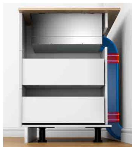
HEZ9VDSB2 Kolanko 90° „L” o dużym promieniu umożliwia wykonanie kanałów w szafce pozostawiając (w odniesieniu do głębokości blatu) maksymalną przestrzeń dla pełnowymiarowych szuflad szafki dolnej.
