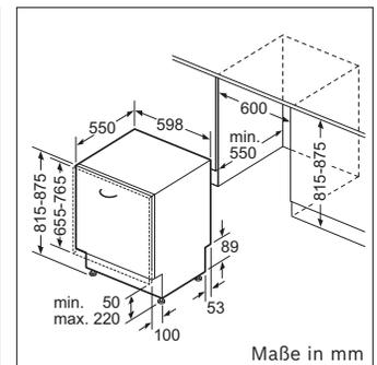
Durch das Vario Scharnier sind Frontgewichte zwischen 4,5 und 11,0 kg möglich, minimale Sockelhöhe 50 mm.
