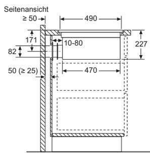
Bei der Installation direkt an einer nicht isolierten Außenwand ( $\mu \geq 0,5 \text{ W/m}^2\text{K}$ ) empfehlen wir die Verwendung von Konfigurationen mit teilweise oder vollständig kanalisierter Rezirkulation.
