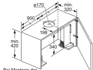
Bei Montage der 90cm Flachschirmhaube in einen 90cm breiten Oberschrank ist ein Montage-Set erforderlich. Die beiden Montagewinkel werden rechts und links im Möbel verschraubt. Montage nach Schablone.
