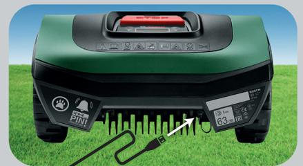
Den Mäher aus der Ladestation nehmen und den Deckel der Software Schnittstelle abschrauben (die Lage des Anschlusses findest Du auf der Seite „Wissenswertes zu Ihrem Indego“ in der Installationsanleitung).
