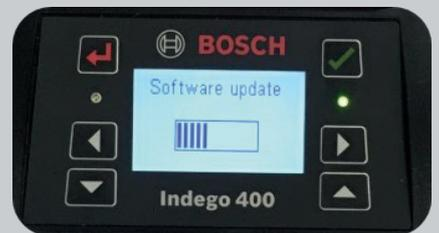
Die Aktualisierung kann bis zu 10 Minuten in Anspruch nehmen. Währenddessen blinkt dauerhaft die rote LED am Mäher. Die LED an der Ladestation schaltet sich während des Vorgangs zu bestimmten Zeitpunkten aus.
