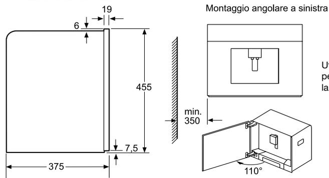
Utilizzando il limitatore di cerniera per una apertura a 92° (ricambio 00636455), la distanza minima al muro può essere di solo 100 mm
