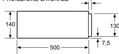
Sopra uno scaldavivande possono essere installati forni compatti con un'altezza apparecchio di 455 mm.
