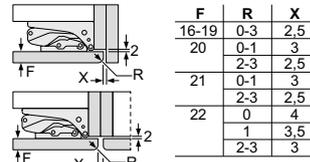
Le distanze consigliate nella tabella vanno mantenute per garantire un'apertura senza collisioni delle porte degli apparecchi ed evitare danni al mobile della cucina.
