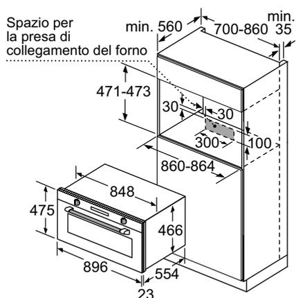
Spazio per la presa di collegamento del forno
