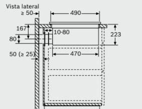
Al realizar la instalación directamente en paredes exteriores no aisladas ( $\mu \geq 0,5 \text{ W/m}^2\text{°C}$ ), recomendamos el uso de configuraciones de recirculación total o parcialmente canalizada.
