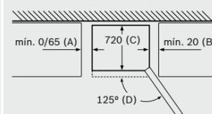
Dimensión A: en modelos con tirador integrado se necesita una distancia mínima de 65 mm para una cómoda apertura de puerta.
