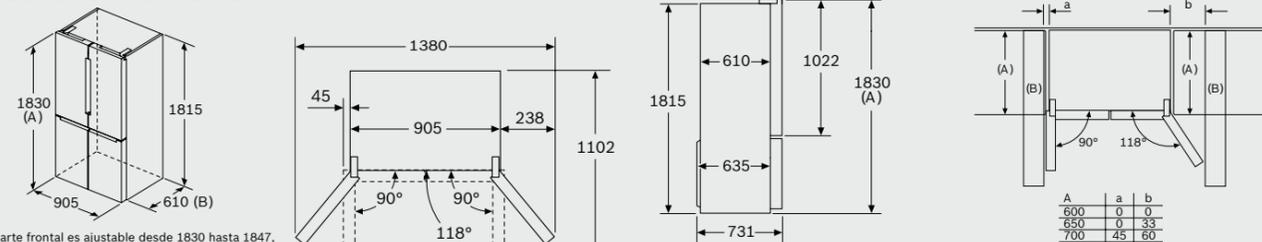
A: La parte frontal es ajustable desde 1830 hasta 1847, con las patas de nivelación totalmente extendidas
