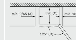
Dimensión A: en modelos con tirador vertical integrado, se requiere una distancia mínima de 65 mm para una apertura sencilla.
