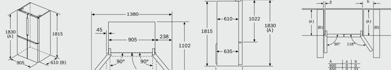
A: La parte frontal es ajustable desde 1830 hasta 1847, con las patas de nivelación totalmente extendidas
