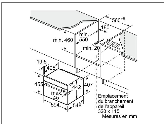
Pour les appareils avec micro-ondes, ventilation dans le socle min. 50 cm<sup>2</sup>.
