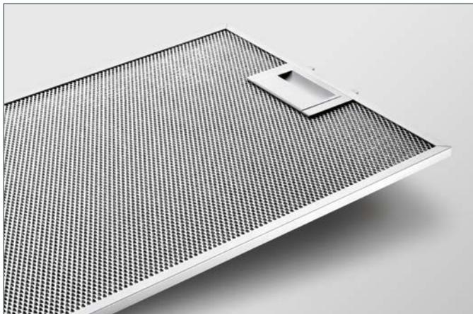
**Filtre antigraisse métallique.** Les filtres antigraisse métalliques sont nécessaires en mode évacuation et recyclage pour filtrer la graisse et d'autres solides dans l'air aspiré. Pour qu'ils gardent leur grande efficacité, il faut les laver une fois par mois, soit à la main, soit au lave-vaisselle.
