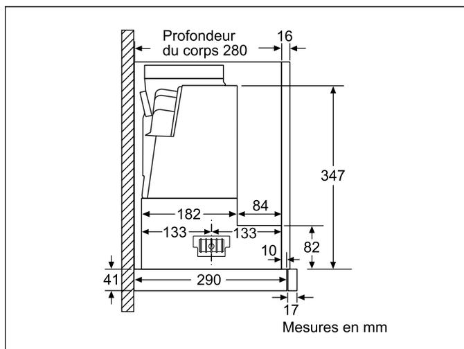
Le panneau de commande de l'extraction ne peut être monté à fleur de plan avec les portes du meuble que si l'appareil a une profondeur d'au moins 305 mm.
