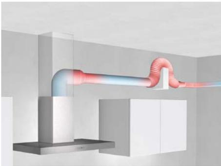
Exemple d'une mauvaise tuyauterie
