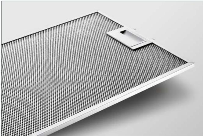
**Metallfettfilter.** Metallfettfilter sind für Abluft und Umluft erforderlich, um Fett und andere Feststoffe aus der eingesaugten Luft zu filtern. Damit die hohe Wirksamkeit erhalten bleibt, sollten sie etwa einmal pro Monat von Hand oder im Geschirrspüler gereinigt werden.
