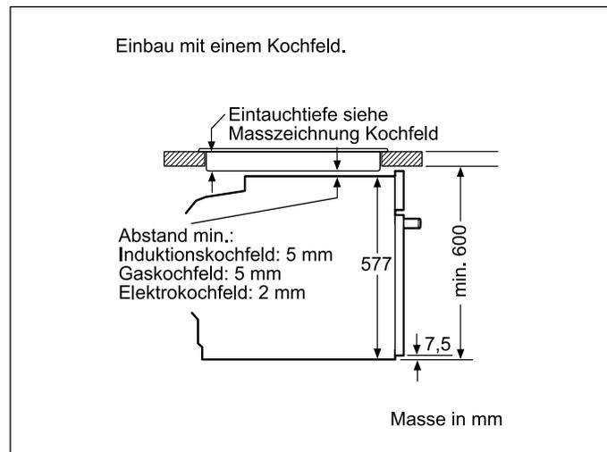
Wird das Gerät unter einem Kochfeld eingebaut, muss folgende Arbeitsplattenstärke (ggf. inkl. Unterkonstruktion) beachtet werden.
