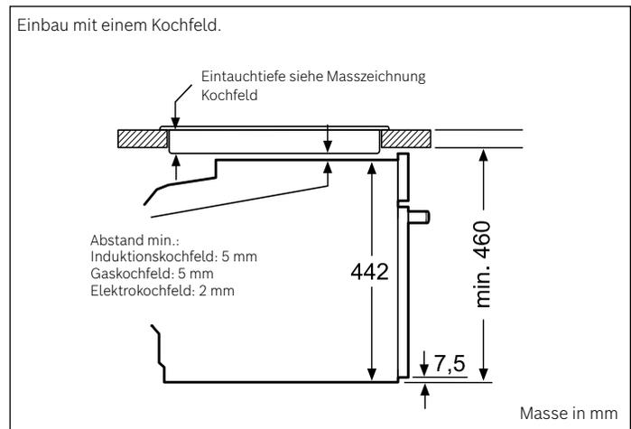
Wird das Gerät unter einem Kochfeld eingebaut, muss folgende Arbeitsplattenstärke (ggf. inkl. Unterkonstruktion) beachtet werden.
