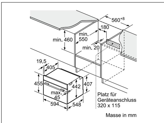
Bei Geräten mit Mikrowelle, Belüftung im Sockel min. 50 cm<sup>2</sup>.
