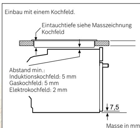
Wird das Gerät unter einem Kochfeld eingebaut, muss folgende Arbeitsplattenstärke (ggf. inkl. Unterkonstruktion) beachtet werden.
