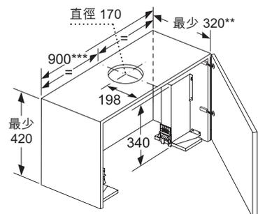
在90厘米闊吊櫃中安裝時，需使用專用安裝組合。兩個安裝支架分別用螺絲固定在吊櫃的左右兩側。請參照安裝手冊。
