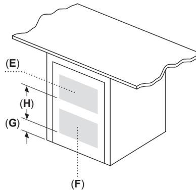
Si le devant de l'appareil est couvert, les ouvertures à persiennes doivent être installées comme indiqué et les dégagements avant/arrière de l'installation en armoire doivent être respectés.
