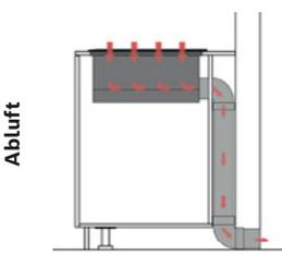
Bitte beachten Sie, dass die Luftführung/Verrohrung im teil- und vollgeführten Umluft- und Abluftbetrieb individuell geplant, bestellt und verbaut werden muss. **Das Rohrsystem ist nicht im Lieferumfang enthalten!**
