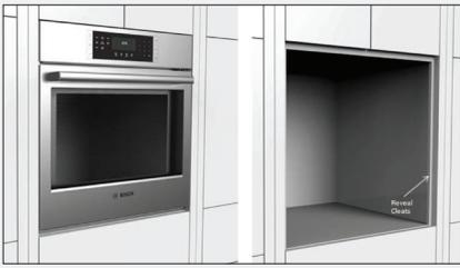
\* Une installation en affleurant nécessite une plaque de base d'une hauteur de  $\frac{3}{16}$  po (5 mm), d'une largeur de  $21\frac{15}{16}$  po (557 mm) et d'une profondeur de  $22\frac{1}{16}$  po (560 mm) sous la partie principale de l'unité.
