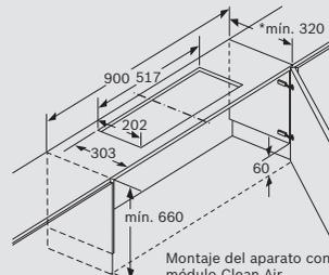
Montaje del aparato con módulo Clean Air y bastidor de descenso
