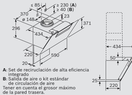
**A:** Set de recirculación de alta eficiencia integrado
