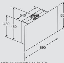
Aparato en recirculación de aire sin canal. Será necesario un juego de recirculación de aire
