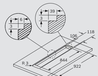
Para el montaje enrasado en encimeras de piedra y de granito
