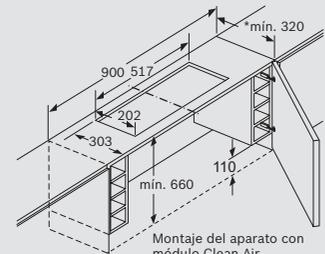
Montaje del aparato con módulo Clean Air y bastidor de descenso
