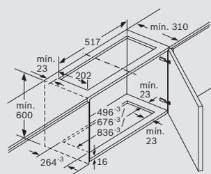
Montaje del módulo Clean Air con campana integrada
