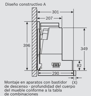
Montaje en aparatos con bastidor de descenso - profundidad del cuerpo del mueble conforme a la tabla de combinaciones
