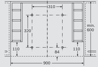
Montaje del aparato con bastidor de descenso
