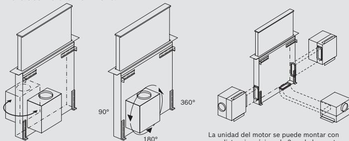
La unidad del motor puede girarse por los cuatro lados y montarse en la parte frontal o en la parte trasera.
