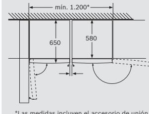
Las bandejas y los cajones se pueden extraer completamente incluso cuando el aparato se encuentra colocado directamente junto a la pared.
