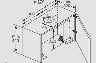
Para el montaje de la campana telescópica de 90 cm en un armario superior de 90 cm de anchura, es necesario un juego de montaje. Ambas escuadras de montaje se atornillan al mueble a derecha e izquierda. Montaje según plantilla.
