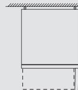
En caso de que se coloque el aparato directamente en la pared, todos los cajones pueden extraerse del todo.
