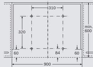
Montaje del aparato con bastidor de descenso
