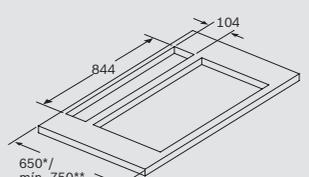
Instalar solo un lado del aparato junto a un mueble alto o pared con distancia de 50 mm
