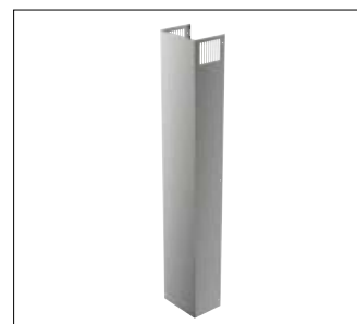
DWZ 0AX5L0: przedłużenie kominy 1500 mm, stal szlachetna. Do okapów kominowych naściennych. Możliwość wydłużenia całkowitej wysokości urządzenia o 1030 mm. Do obiegu zamkniętego lub otwartego. Przedłużenie szczelinami do pracy w obiegu zamkniętym.
