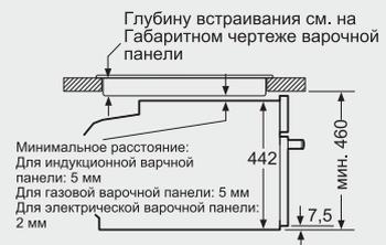
При встраивании мелких бытовых приборов под варочной панелью, необходимо учитывать требования к толщине столешницы (включая усиливающий элемент).
