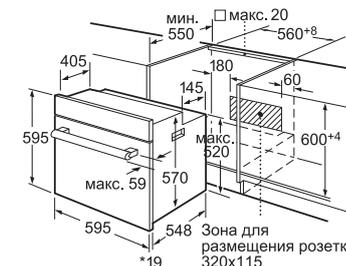
\*При металлической фронтальной панели 20 мм
