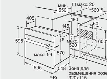
\*При металлической фронтальной панели 20 мм
