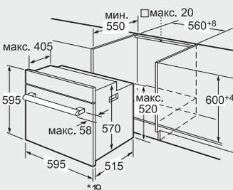
\* При металлической фронтальной панели 20 мм
