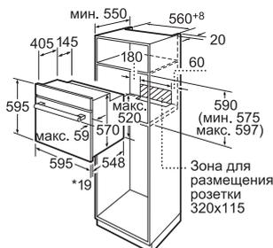
\*При металлической фронтальной панели 20 мм
