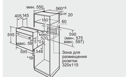
\*При металлической фронтальной панели 20 мм
