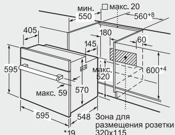
\*При металлической фронтальной панели 20 мм
