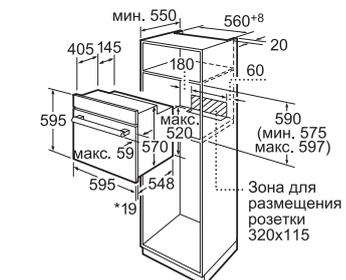
\*При металлической фронтальной панели 20 мм
