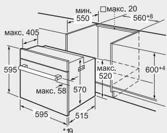
\* При металлической фронтальной панели 20 мм
