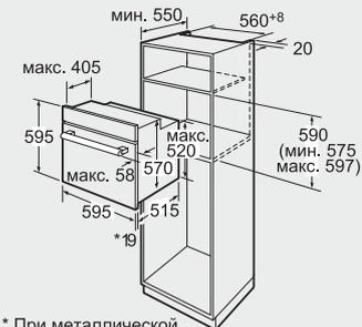
\* При металлической фронтальной панели 20 мм
