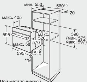
\* При металлической фронтальной панели 20 мм
