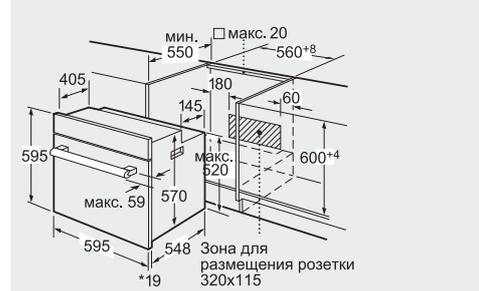
\*При металлической фронтальной панели 20 мм
