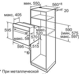
\* При металлической фронтальной панели 20 мм
