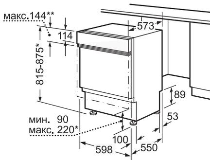
\*\* Панель из нержавеющей стали макс. 143 мм
