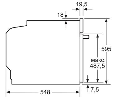
При встраивании прибора под варочную панель, необходимо учитывать требования к толщине столешницы (включая усиливающий элемент).
