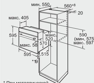
\* При металлической фронтальной панели 20 мм
