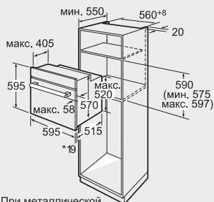
\* При металлической фронтальной панели 20 мм
