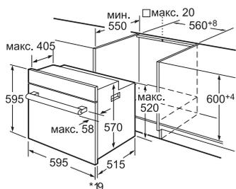
\* При металлической фронтальной панели 20 мм
