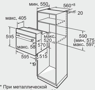
\* При металлической фронтальной панели 20 мм
