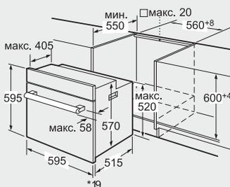
\* При металлической фронтальной панели 20 мм
