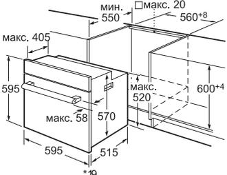
\* При металлической фронтальной панели 20 мм
