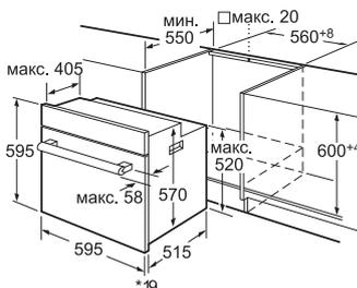
\* При металлической фронтальной панели 20 мм
