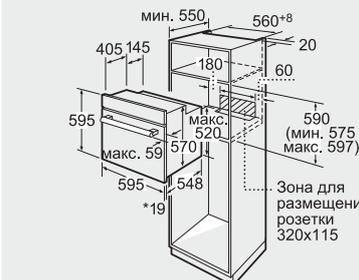
\*При металлической фронтальной панели 20 мм
