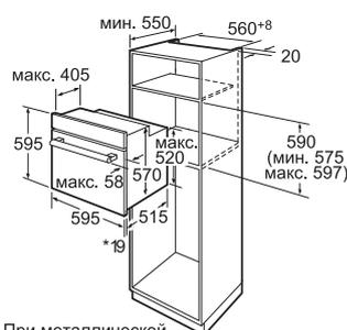
\* При металлической фронтальной панели 20 мм
