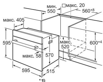
\* При металлической фронтальной панели 20 мм
