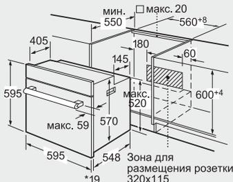
\*При металлической фронтальной панели 20 мм
