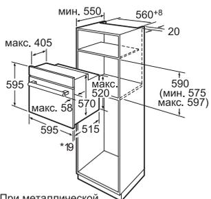
\* При металлической фронтальной панели 20 мм
