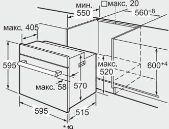
\* При металлической фронтальной панели 20 мм
