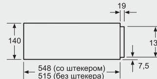
Над шкафом для подогрева посуды можно устанавливать компактный духовой шкаф высотой 455 мм. Разделительная перегородка не требуется.
