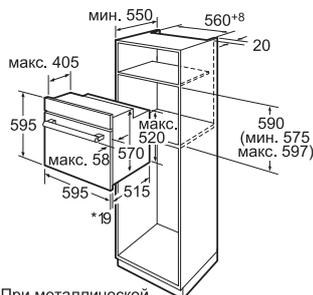
\* При металлической фронтальной панели 20 мм
