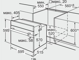
\* При металлической фронтальной панели 20 мм
