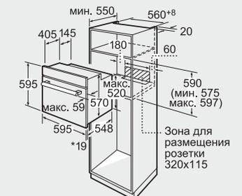
\*При металлической фронтальной панели 20 мм
