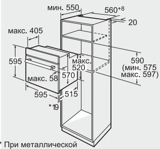
\* При металлической фронтальной панели 20 мм
