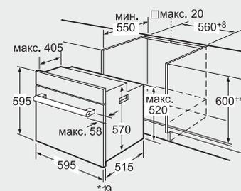
\* При металлической фронтальной панели 20 мм
