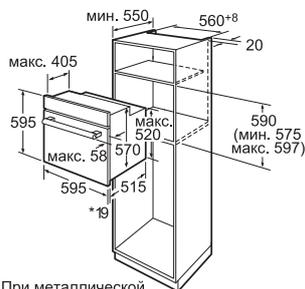
\* При металлической фронтальной панели 20 мм
