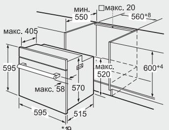
\* При металлической фронтальной панели 20 мм
