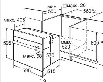
\* При металлической фронтальной панели 20 мм
