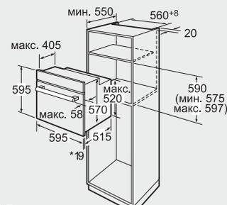
\* При металлической фронтальной панели 20 мм
