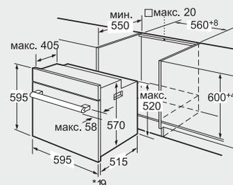
\* При металлической фронтальной панели 20 мм
