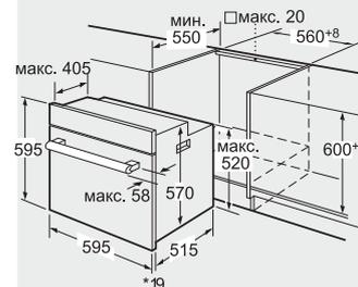
\* При металлической фронтальной панели 20 мм
