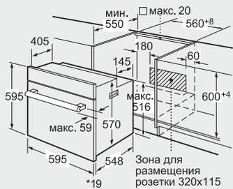
\* При металлической фронтальной панели 20 мм
