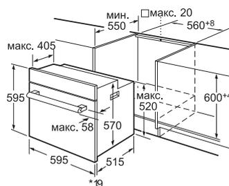
\* При металлической фронтальной панели 20 мм
