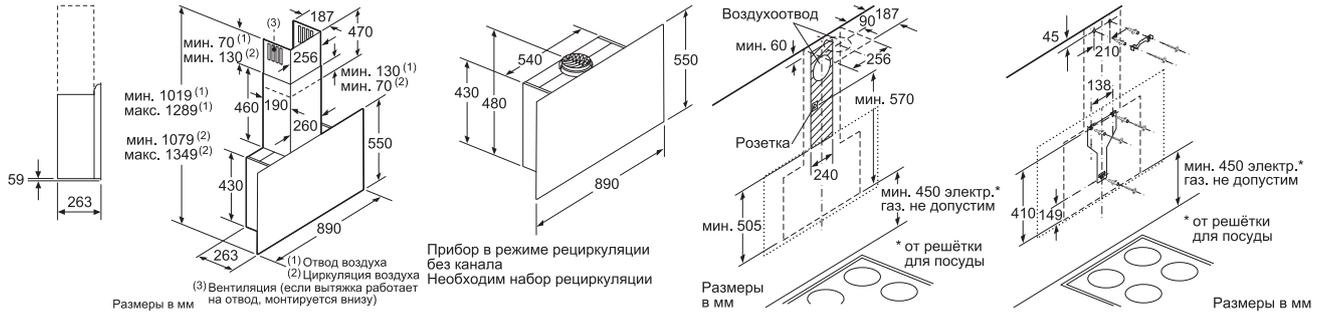
**Вытяжка для потолочного монтажа**
