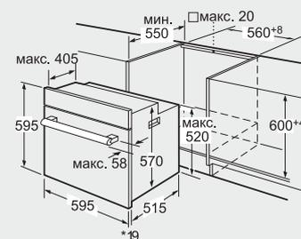
\* При металлической фронтальной панели 20 мм
