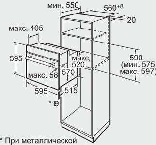
\* При металлической фронтальной панели 20 мм
