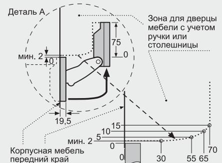
При встраивании прибора под варочную панель необходимо учитывать требования к толщине столешницы (включая усиливающий элемент).
