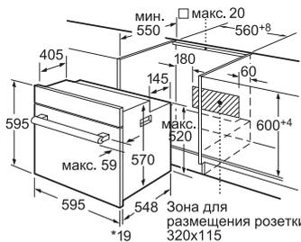
\*При металлической фронтальной панели 20 мм
