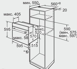
\* При металлической фронтальной панели 20 мм
