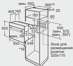
\*При металлической фронтальной панели 20 мм
