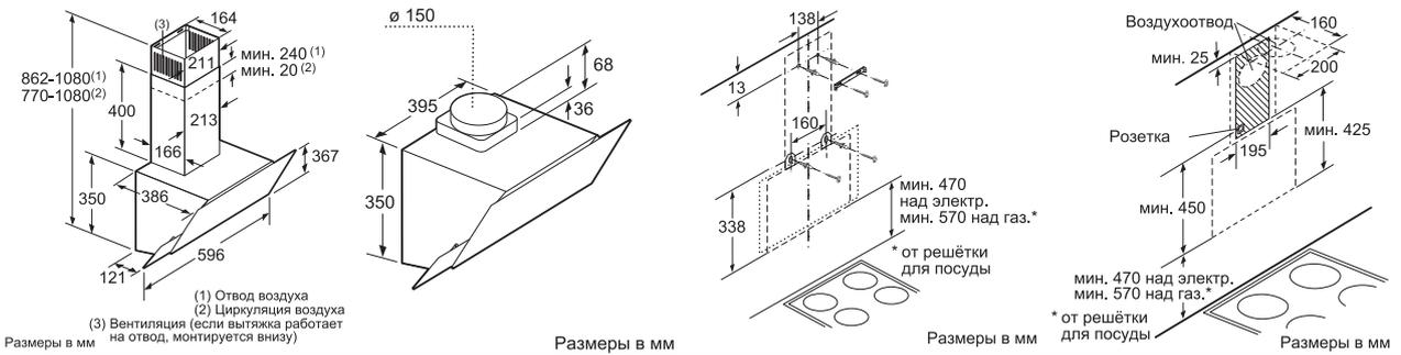
**Вытяжка для потолочного монтажа**
