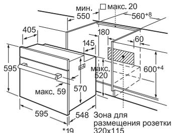
\*При металлической фронтальной панели 20 мм
