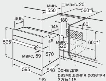
\*При металлической фронтальной панели 20 мм
