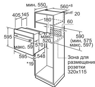
\*При металлической фронтальной панели 20 мм
