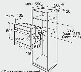
\* При металлической фронтальной панели 20 мм
