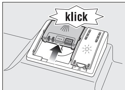
洗滌劑槽依洗程需要，將會在最佳時刻自動打開。粉狀或液體狀洗滌劑會在機器中分散並溶解，洗碗碇會掉入洗碗碇槽中並在那裡逐漸溶解。
