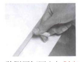
5.將附層板固定架對齊 洗衣機後以鉛筆標示 鑽孔位置,先行引孔
