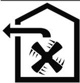
L'air ne doit pas être acheminé dans une cheminée servant à l'évacuation des gaz d'appareils qui sont utilisés pour la combustion de gaz ou d'autres combustibles (cela ne s'applique pas aux appareils de recyclage).
