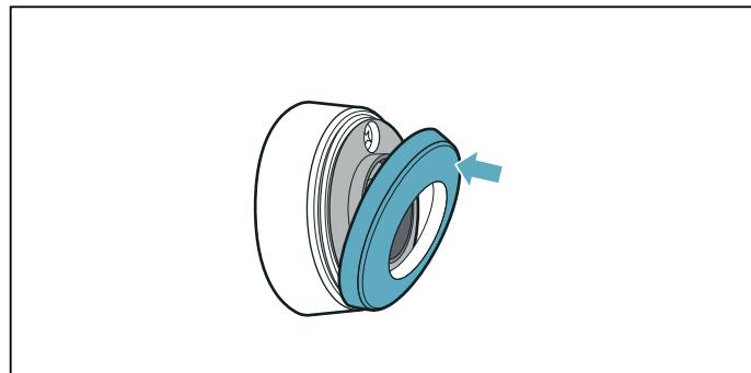
**Bemærk:** Brug kun kvalitetsbatterier af typen CR2032, som har en længere levetid.
