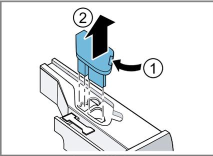
5. Den Deckel der Waschmittelschublade entrasten und entfernen.
