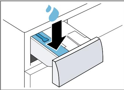
6. Das Pulvervollwaschmittel in die Kammer für manuelle Dosierung einfüllen.
