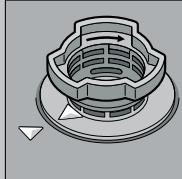
kierrä siiviläjärjestelmä kiinni. HUOMIO MERKIT!
