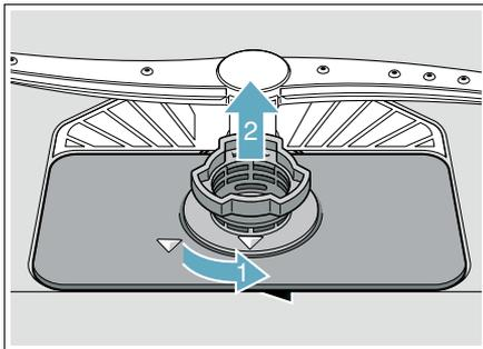
2. Retirez le microfiltre du filtre fin pour faciliter le nettoyage.
