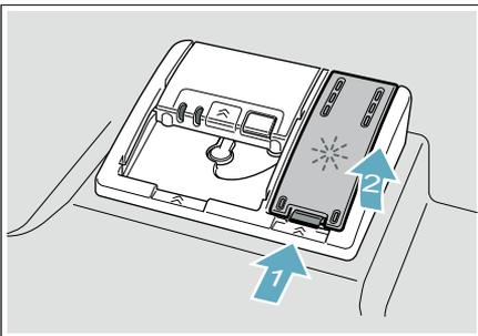
2. Ajoutez le produit de rinçage liquide au distributeur [32] à pleine capacité. Ne le remplissez pas outre mesure. Évitez tout déversement dans le trou d'aération.
