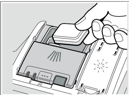
Ne versez du détergent que dans le distributeur de détergent sec [33]. Ajoutez le détergent. Ne remplissez pas le distributeur de détergent outre mesure.
