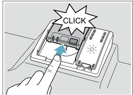
Le distributeur de détergent s'ouvrira automatiquement au moment approprié pour le cycle défini. Le détergent liquide ou en poudre est dispersé dans l'appareil et dissout, les comprimés détergents tombent dans le compartiment à détergent [24] où ils se dissolvent tout au long du cycle.
