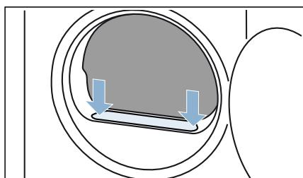
**Anvisning:** Silen i kondensattanken filtrerar kondensatet till autorengöringen av maskinen. Rengör silen genom att tömma ur kondensatet. Kontrollera om det finns avlagringar i silen med jämnna mellanrum och ta bort dem, om det behövs.
