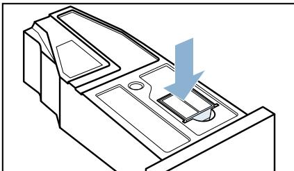
12. Skjut in kondensattanken så att den snäpper fast.
