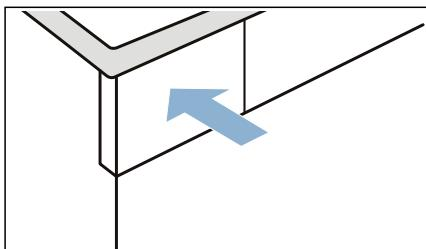
**Anvisning:** Silen i kondensattanken filtrerar kondensatet till autorengöringen av maskinen. Rengör silen genom att tömma ur kondensatet. Kontrollera om det finns avlagringar i silen med jämnare mellanrum och ta bort dem, om det behövs.
