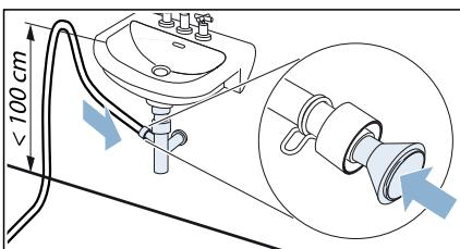
Fäst anslutningen med slangklämma (spänvidd 12-22 mm, finns att köpa i fackhandeln).
