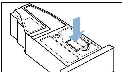
12. Skjut in kondensattanken så att den snäpper fast.
