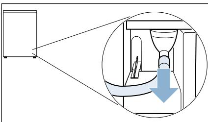
**Napomena:** U isporučenom stanju uređaja je crijevo kondenzata pričvršćeno na nastavak.
