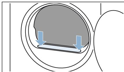
4. Razvucite dvodijelni filter za niti.
