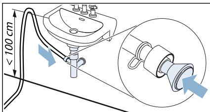
Мястото на свързване трябва да бъде подсигурено с халка за закрепване на тръба (диапазон на захват 12-22 мм, от търговската мрежа).
