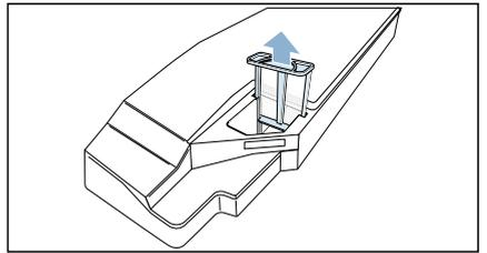
4. Lavare il filtro sotto l'acqua corrente calda oppure in lavastoviglie.
