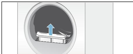
3. Uklonite tanke niti iz udubljenja sita za kratke niti.
