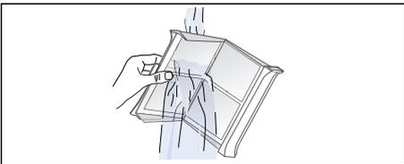
7. Osušite sita za kratke niti, sklopite ih i dvodelno sito za kratke niti ponovo umetnite u mašinu.
