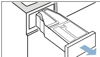
9. Poussez le réservoir d'eau de condensation jusqu'à ce qu'il s'enclenche.
