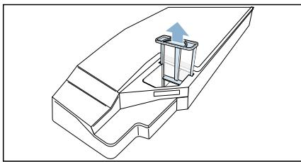
11. Placez le filtre dans la cavité du réservoir d'eau de condensation.
