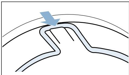
Le panier pour lainages doit maintenant être fixé au capot avant.
