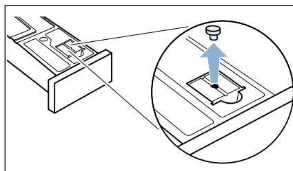
3. Retournez le réservoir d'eau de condensation à 180° (face supérieure en bas) puis mettez en place le bouchon.
