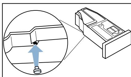
Le réservoir d'eau de condensation est à présent préparé pour l'entretien de l'appareil.
