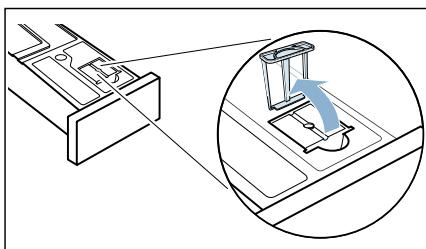
2. Retirez le bouchon de la cavité du réservoir d'eau de condensation.
