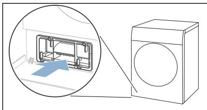
**Remarque :** Vous pouvez uniquement insérer le couvercle de l'échangeur thermique lorsque l'insert se trouve dans l'appareil.
