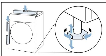
3. Si nécessaire, réalignez l'appareil en tournant les pieds de l'appareil.
