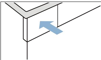
**Anvisning:** Silen i kondensattanken filtrerar kondensatet till autorengöringen av maskinen. Rengör silen genom att tömma ur kondensatet. Kontrollera om det finns avlagringar i silen med jämma mellanrum och ta bort dem, om det behövs.
