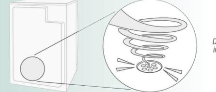
Das Kondenswasser wird mit einer Pumpe in den Kondenswasser-Behälter gepumpt, dabei entstehen Pumpgeräusche.
