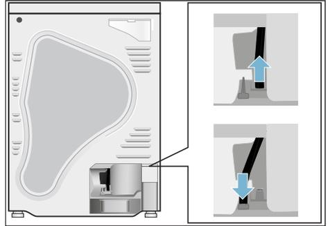
4. Prendere il tubo di scarico dagli accessori e fissarlo al manicotto vuoto. Spingere il tubo di scarico nella guida del tubo flessibile.
