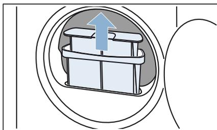
3. Odstráňte vlákna z priehlbiny sitka na vlákna. Dávajte pozor na to, aby do otvorenej šachty nespadli vlákna.
