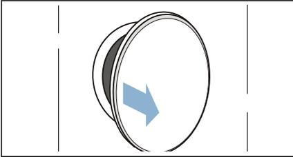
2. Snímač vlhkosti vyčistite zdrsnenou špongiou.
