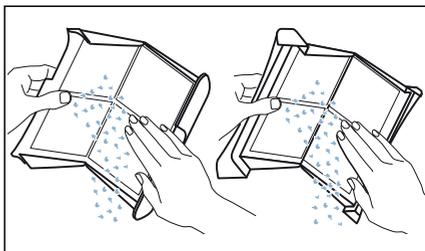
7. Vlákna spláchnite pod teplou tečúcou vodou.
