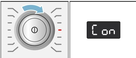
4. Wählen Sie die Starttaste. Im Anzeigefeld erscheint **on** (eingeschaltet). Die Wi-Fi Funktion ist jetzt am Gerät eingeschaltet. Im Anzeigefeld erscheint **off** (ausgeschaltet). Die Wi-Fi Funktion ist jetzt am Gerät ausgeschaltet.
