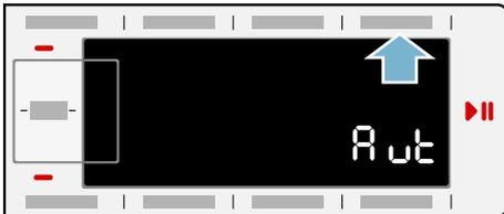
3. Wählen Sie die Starttaste um sich zu verbinden. Im Anzeigefeld blinkt
