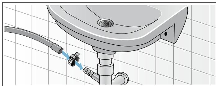
Fixez le tuyau de drainage au siphon d'évier à l'aide d'un collier de serrage de 0,9 - 1,6 po (20 à 44 mm) de diamètre (offert dans les quincailleries).
