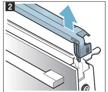
**Avvertenza:** Pulire la struttura in acciaio inossidabile nella copertura con un apposito detergente. Pulire la parte restante della copertura della porta con una soluzione di lavaggio calda e un panno morbido.
