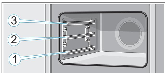
Ai livelli di inserimento 1, 2 e 3, inserire l'accessorio sempre tra entrambe le aste di guida di un livello di inserimento.
